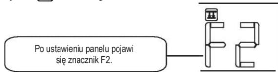
2. Nacisnąć przycisk „+” i „-”, aby sterować podnoszeniem i opuszczaniem panelu. Naciśnięcie przycisku „+” umożliwia zatrzymanie panelu podczas opuszczania. Naciśnięcie przycisku „-” umożliwia zatrzymanie panelu podczas podnoszenia.
