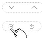
Cuando la unidad de aire acondicionado está apagada, estando en la función de consulta de temperatura, pulse “ $\swarrow$ ” o “ $\nwarrow$ ” para seleccionar tyPE. Pulse “Confirm (Confirmar)” para estado de configuración,
